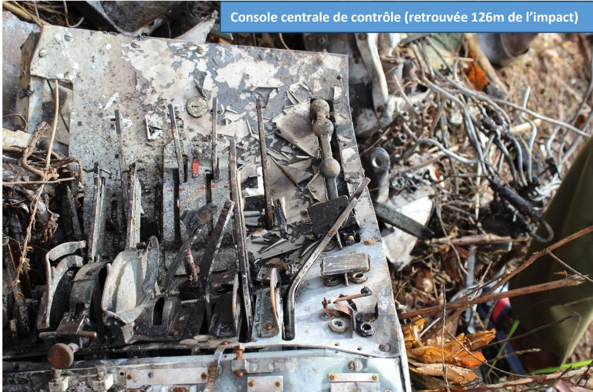
Des éléments du mécanisme des gouvernes de profondeur et de direction ont été retrouvés détachés de l'épave de l'avion.
