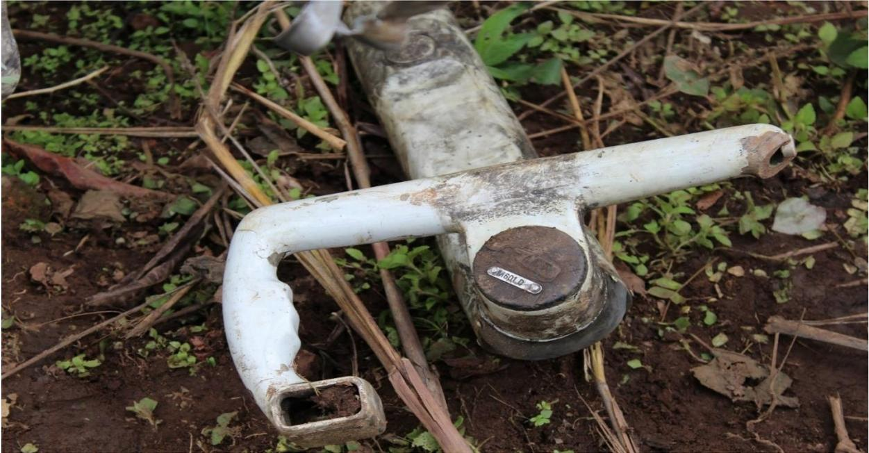
Les deux moteurs ont quitté leur loge pour s'écraser séparément. Toutes les aubes de fan sont rompues. Les éléments tournants des moteurs sont fortement endommagés. Les éléments des moteurs identifiés ne présentent pas de traces visibles d'incendie.
