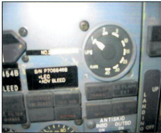
L'indicateur de la position des volets montre que les volets étaient à 1°
