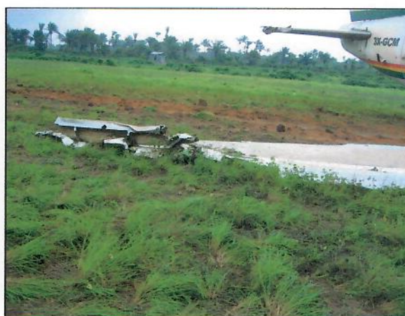
L'aile droite et le bout de l'empennage horizontal droit sont fortement endommagés
