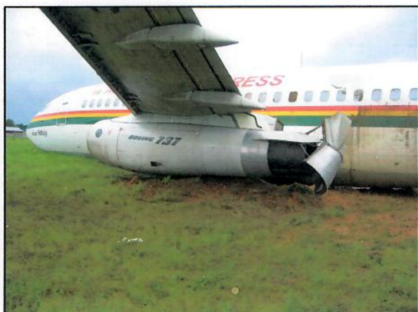
Vue de l'avion avec le moteur gauche dont les inverseurs de poussée ont été déployés
