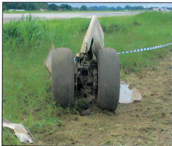
Vues du train d'atterrissage droit avec une partie de l'empennage horizontal droit arraché par le train et coincé entre ses deux roues.
