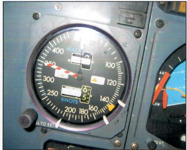
Les vitesses V1=135, Vr=137 et V2=143 kts correspondent aux vitesses pour volets 5 pour une TOW de 50 tonnes.
