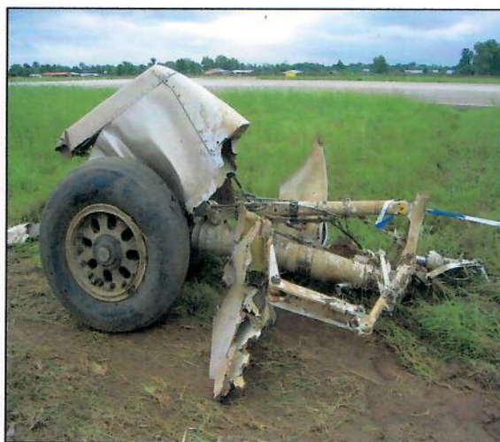
Vues du train d'atterrissage droit avec une partie de l'empennage horizontal droit arraché par le train et coincé entre ses deux roues.
