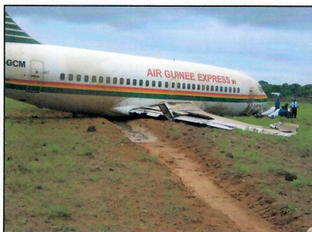
Vue de l'avion sans le moteur et le train d'atterrissage droits. Le sillon est creusé par le train d'atterrissage gauche
