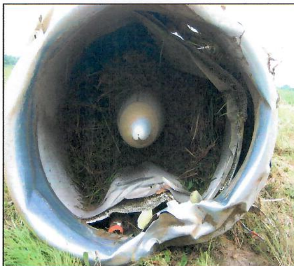
Moteur droit vu de face avec les herbes aspirées.
