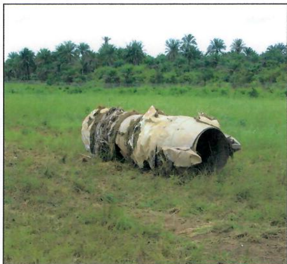
Le moteur droit s'est détaché de l'avion et a pivoté de 180° par rapport à la trajectoire.
