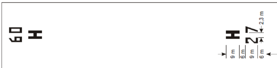
Figure 5-2. Marque d'identification de FATO et marque distinctive d'hélistation pour une FATO de type piste
