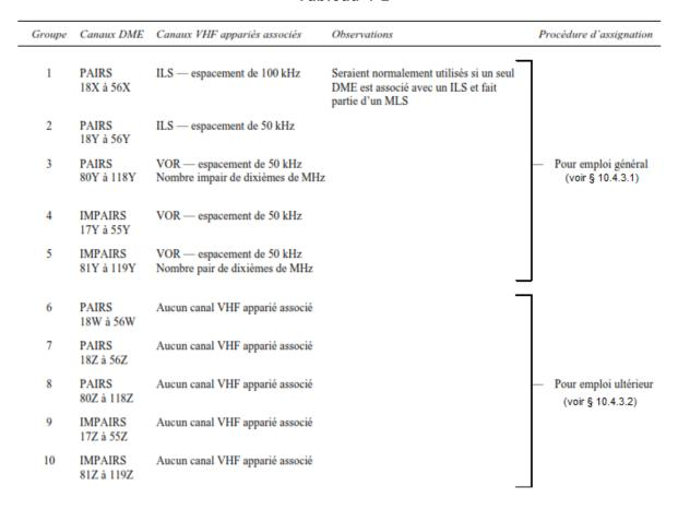
Note.— Les canaux DME des groupes 1 et 2 peuvent être utilisés en association avec les canaux ILS et/ou MLS. Les canaux DME des groupes 3, 4 et 5 peuvent être utilisés en association avec les canaux VOR ou MLS.
